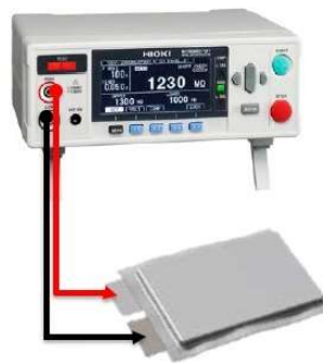
注入电解液之前的电极间绝缘电阻测量
