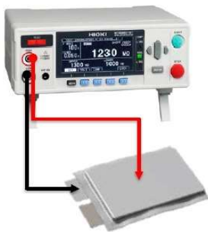
电极-电池外壳间的绝缘电阻测量
